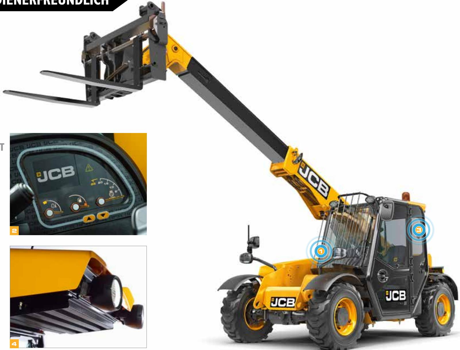
6 Die Bedienung eines JCB 525-60 Hi-Viz ist komfortabel, präzise und einfach: Sie erfolgt über die elektrische Einhebel-Servosteuerung mit proportionalen Zusatzkreisen.
