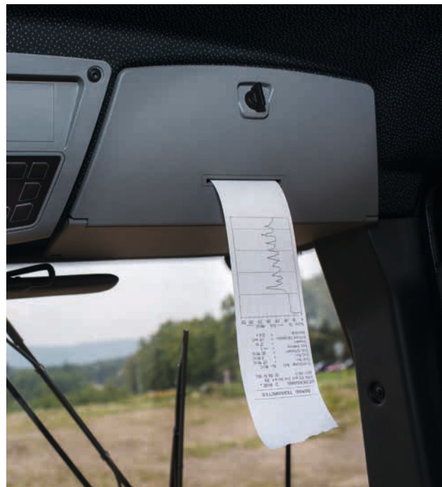
Integrierter Drucker: für die Dokumentation der Verdichtungswerte.
