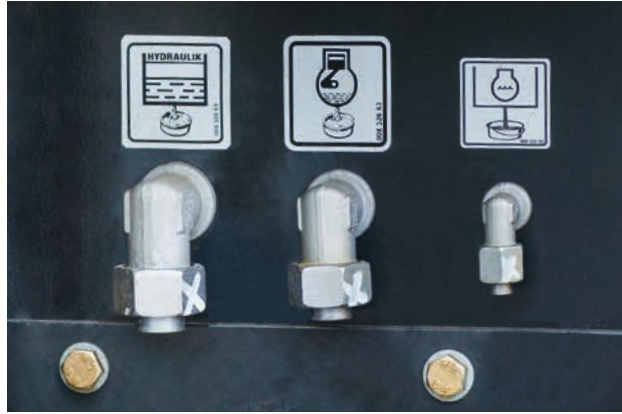
Intelligent: Betriebsmittel können von außen abgelassen werden.
