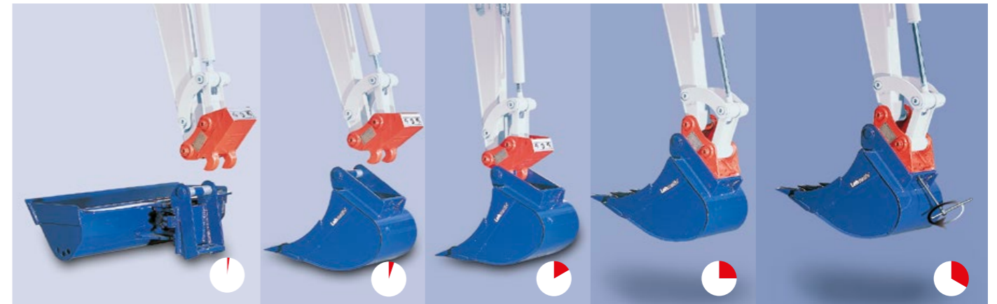
Ausklinken Einfahren Einklinken Anheben und Einkippen Verriegeln
