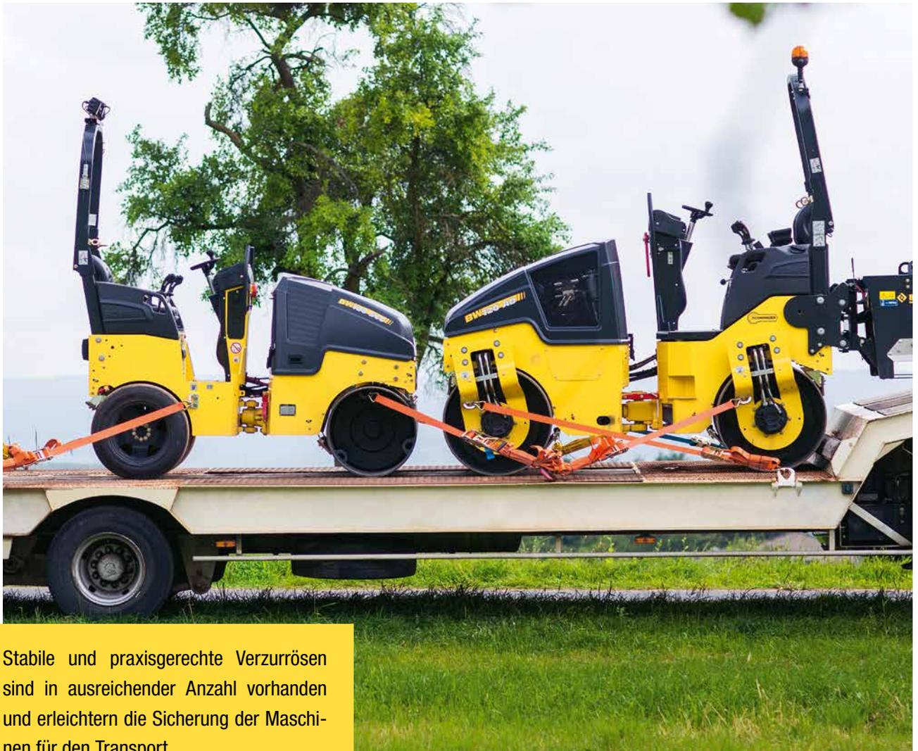
Stabile und praxiserichte Verzurrösen sind in ausreichender Anzahl vorhanden und erleichtern die Sicherung der Maschinen für den Transport.
