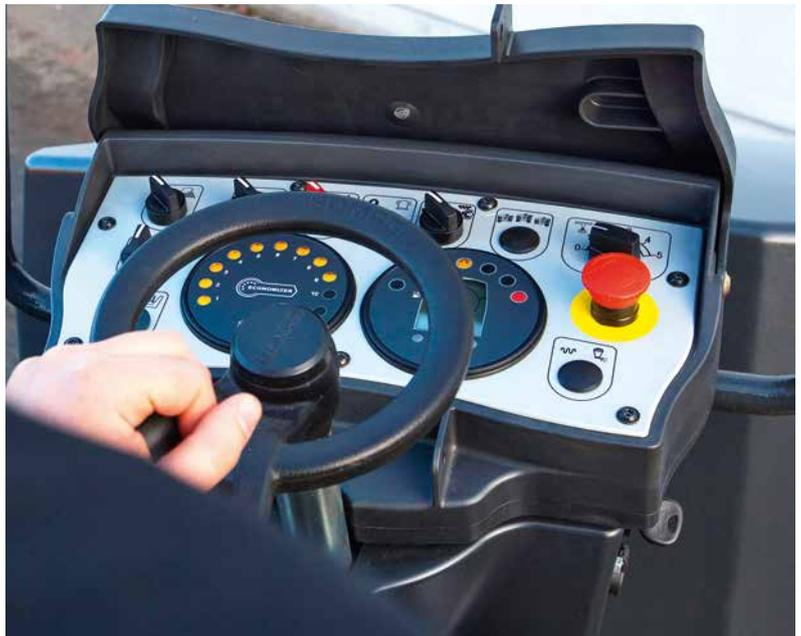
Große Schalter, ein kompaktes Lenkrad und eine übersichtliche Anordnung aller Bedienelemente vereinfachen jedem Bediener die Arbeit mit einer leichten BOMAG Tandemwalze.
