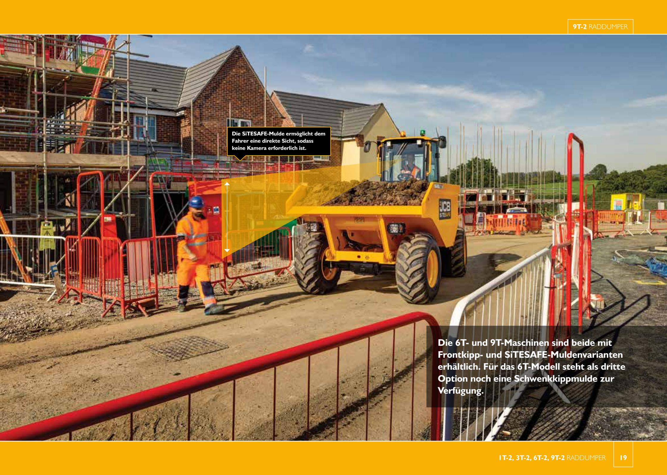
Die SiTESAFE-Mulde ermöglicht dem Fahrer eine direkte Sicht, sodass keine Kamera erforderlich ist.
