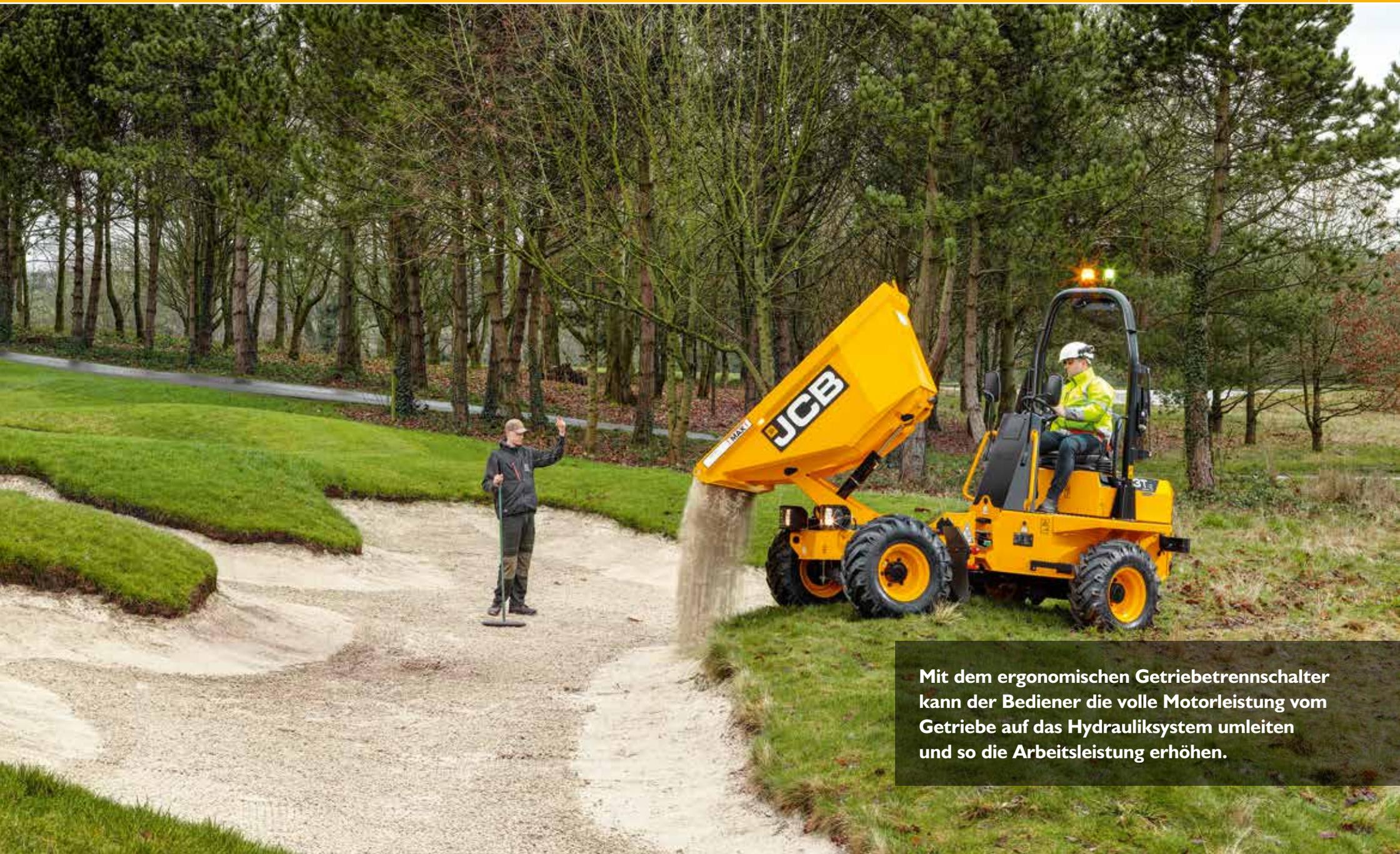
Mit dem ergonomischen Getriebetrennschalter kann der Bediener die volle Motorleistung vom Getriebe auf das Hydrauliksystem umleiten und so die Arbeitsleistung erhöhen.
