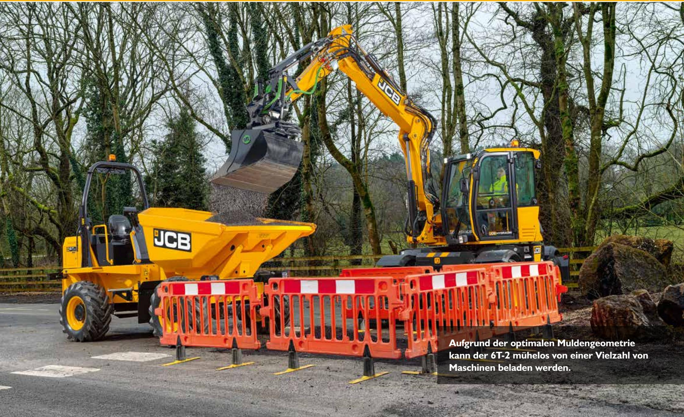
**Aufgrund der optimalen Muldengeometrie kann der 6T-2 mühelos von einer Vielzahl von Maschinen beladen werden.**
