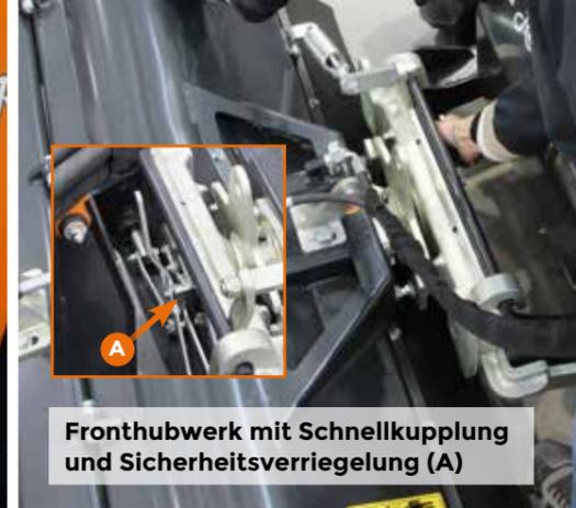
Fronthubwerk mit Schnellkupplung und Sicherheitsverriegelung (A)
