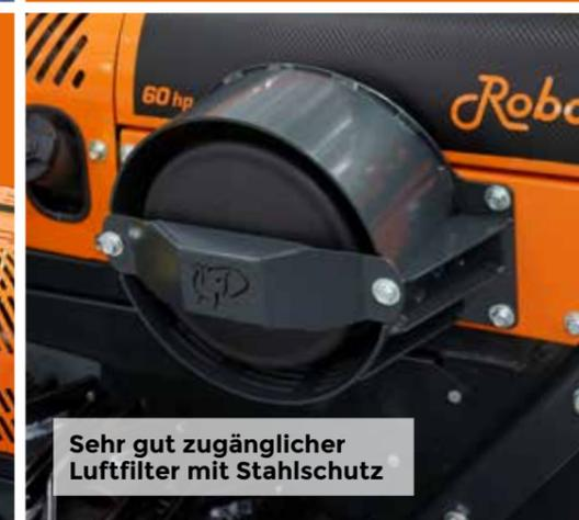
Sehr gut zugänglicher Luftfilter mit Stahlschutz
