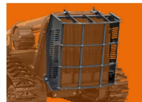
Klappbarer Kühlerschutz aus Stahl
