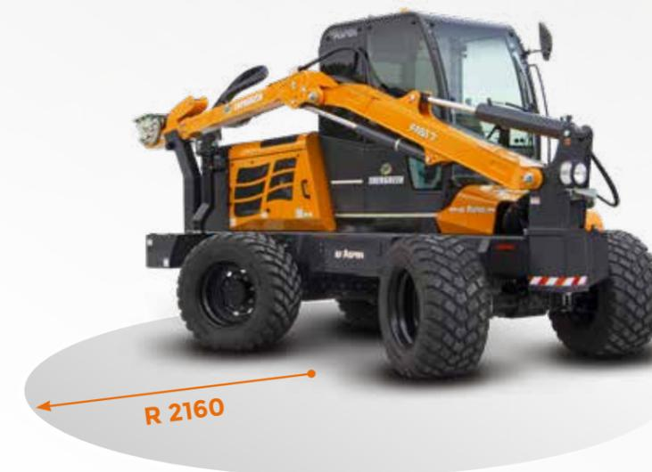
Die Vielseitigkeit dieser Maschine spiegelt sich auch im Allradantrieb und der Lenkung wider. Alle 4 Räder sind gelenkt, von der Fahrerkabine aus können 3 Lenkungsarten eingestellt werden:
