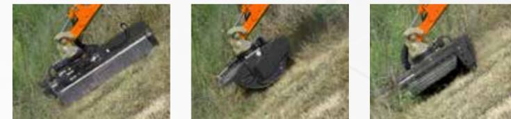
HYDRAULISCHER DREHKRANZ FÜR DIE 180°-DREHUNG DER ANBAUGERÄTE
